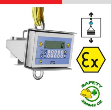
Kranwaagen, klassifiziert für Wägeanwendungen in explosionsgefährdeten ATEX-Bereichen (Zone 1 und 21, 2 und 22), mit Schutzart gemäß Ex II 2GD IIC T4 T197°C X.
